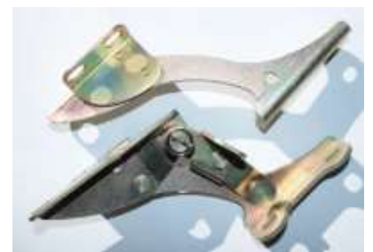
44年用ボンネットヒンジ 44年専用のボンネットの角度が違ふタイプです。グリルに干渉してしまうため専用設計です。
