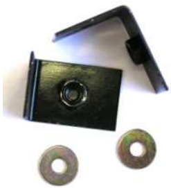
フロントバンパー コーナーブラケット バンパー両端のフェンダーの間のブラケットです。
