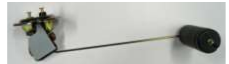
ガソリンタンクゲージ メーター残量にズレがある車両は、この部品をまず疑ってみてください。
