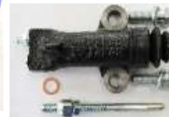
クラッチリリース シリンダー ボルト、ガスケット付属。 OH するより Assy 交換 の方が確実です。MT 全 車共通。 ¥11,870-
