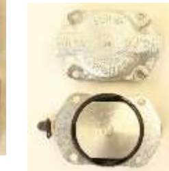
キャリバーピストンキット インナー、アウター別売です が修理するなら同時交換し ましょう。 インナー (上) 1個¥8,750- アウター (下) 1個¥8,290-
